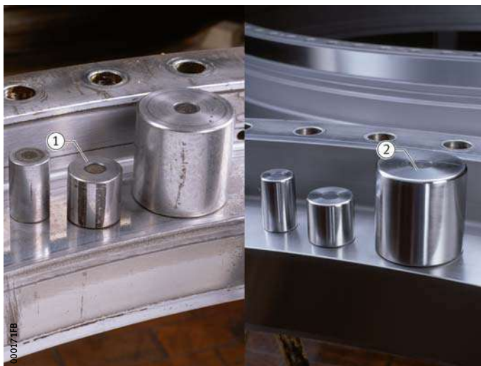
Ilustr. 7 Bieżnia i wateczki łożysk tocznych przed i po regeneracji
